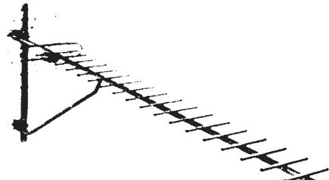
Приклади зовнішнього вигляду ефірних приймальних антени для прийому сигналів цифрового мовлення DVB-T2 з коефіцієнтом підсилення більше 10 дБ.
